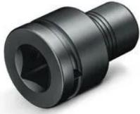
适用于冲击扳手的 VARIO 转接器还可以将冲击扳手变成攻丝机，从而为加工应用增添另一种机器。用于带有 3/4" 外四方夹头的所有冲击扳手。|无需工具即可轻松更换 FEIN VARIO 耗材，无需操作锁定套筒即可轻松插入。适用于所有 FEIN VARIO 配件 - 麻花钻头、锥形镗钻和丝锥。方便对 M30 以下的螺纹进行机械精攻丝。|对于 M18 以下尺寸，我们建议将 FEIN VARIO 转接器 1/2" 与较小的机器配合使用，以进行更为精细的作业，并且耗材的断裂风险更小。与手电钻或手动工具相比，冲击扳手动力量更为强劲，攻丝清屑时更加轻松。|转接器易于插接，并可借助卡簧或卡环固定，以便长期使用。
