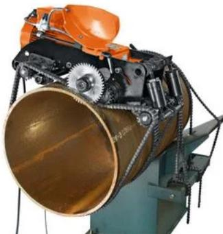
爬行式管道切割坡口机，可用于  $\varnothing 250 \text{ mm} \sim \varnothing 1500 \text{ mm}$  的管道
