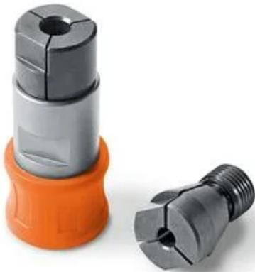
Adaptador de furadeira de rosca com 2 pinças de aperto para encabadores de 4,5 e 6 mm de diâmetro para cortar roscas de tamanho M4/M5/M6/M8. Fixação confiável da furadeira de rosca no encaixe quadrado, que impede o deslizamento.
