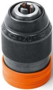
Bucha de fixação totalmente metálica da marca Röhm com mordente de fixação de metal duro e elevadas forças de aperto. O bit de parafusamento pode permanecer no veio de acionamento, a bucha de fixação passa por cima do bit. Torque máximo 120 Nm.
