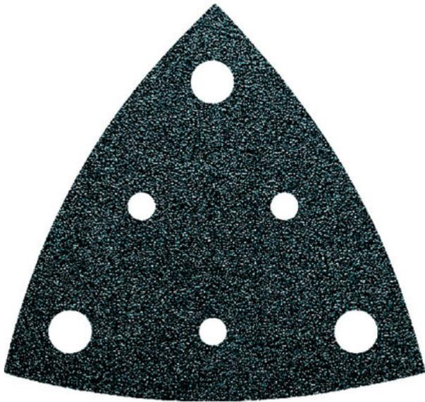
Haut rendement de ponçage, faible encrassement et longue durée de vie garantis grâce à des grains abrasifs en corindon et au liant en résine synthétique. Pour une utilisation sur pratiquement tous les matériaux. Perforées, pour une utilisation avec patin de ponçage perforé et dispositif d'aspiration des poussières, fixation auto-agrippante.
