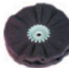
Disques fibres plissé, largeur env. 30 mm, alésage 14 mm, pour des travaux d'ébarbage léger, désoxydation, travaux de meulage léger, travaux de décoration
