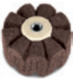
Roue fibre Sinus Alésage 19 mm Ø 100 x 50 mm, avec onde sinusoïdale, pour un fini satiné lisse
