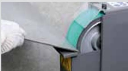
Préparation des cordons de soudure pratiquement sans vibrations, rendement maximal et faibles coûts matériels : avec la qualité de bandes GRIT « R ».
