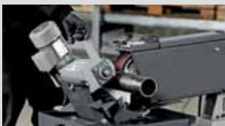
Module de ponçage de tubes GRIT GIC : préparation de la surface de tubes pour le polissage.
