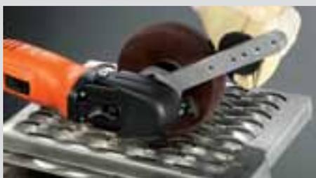
Nettoyage rapide et efficace de profilés: le disque fibre plissé s'adapte parfaitement à toutes les structures.
