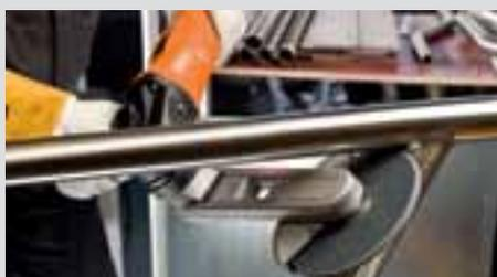
Poncer les soudures d'angle: du ponçage des soudures d'angle jusqu'au poli miroir avec la ponceuse pour soudeuse d'angle KS 10-38 E.
