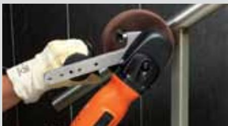
La ponceuse-polisseuse WPO 14-25 E: éliminer efficacement les couleurs de revenu. Les disques fibre plissés s'adaptent parfaitement à toutes les formes de pièces à travailler.
