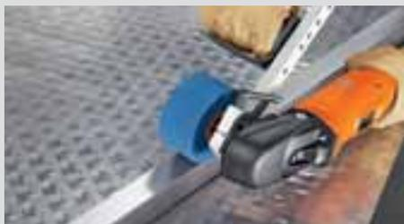
Pour les profilés en acier inoxydable et les matériaux plats: fini satiné avec les roues élastiques et les roues fibres.
