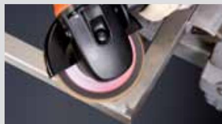
Disque à lamelles FEIN medium pour l'élimination de cordons de soudure fins sans endommagement des surfaces adjacentes.
