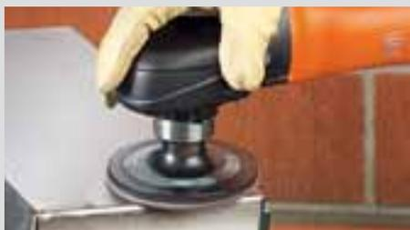
Éliminer efficacement les couleurs de revenu avec le disque fibre plissé ou disque fibre. Pour une adaptation optimale sur les cordons de soudure.
