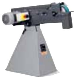
Ponceuse à bande universelle modulable pour les applications de métal dans l'artisanat, idéale pour le travail sur l'acier inoxydable en petites séries.
