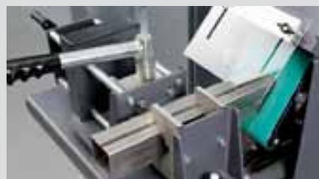
Ponçage de précision en biais avec un gabarit de ponçage en combinaison avec GIR.
