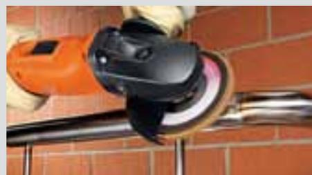
Élimination de cordons de soudure sans endommagement des surfaces adjacentes: avec le disque à lamelles FEIN spéciale medium.
