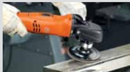
Préparation optimale pour le polissage de profilés avec les disques Pyramix.
