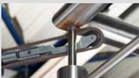
Idéale pour les endroits difficiles d'accès : la lime à bande BF 10-280 E avec le bras de ponçage orientable.
