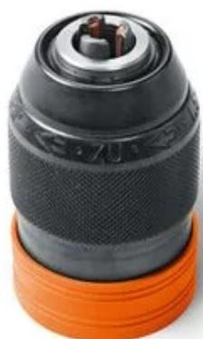
Mandrino portapunta in metallo pieno di marca Röhm con ganasce in metallo duro e forze di serraggio elevate. Il bit dell'avvitatore può restare montato sull'albero portautensile, il mandrino portapunta si sposta sopra il bit. Coppia massima 120 Nm.
