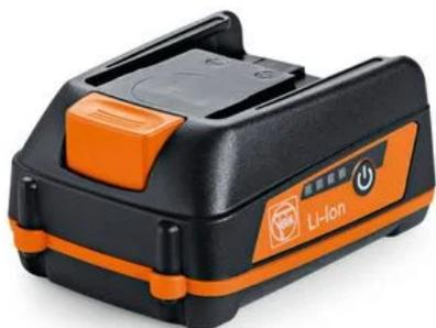
Batteria agli ioni di litio con indicatore dello stato di carica e FEIN SafetyCell Technology. Protezione della batteria e della macchina da sovraccarichi, surriscaldamento e scarica profonda. Può essere utilizzata su tutti gli utensili a batteria FEIN da 12 e 18 V con presa MultiVolt.
