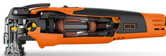
Didascalia: Per proteggere al meglio gli utilizzatori: il sistema antivibrazioni FEIN riduce le vibrazioni e aumenta la silenziosità di funzionamento. La carcassa è isolata completamente grazie a elementi ammortizzanti elastici.
