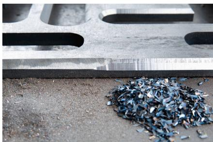
Didascalia: Vantaggi in termini di salute: quando l'operatore lavora i bordi del pezzo in lavorazione con una smussatrice, si formano solo trucioli di metallo e non polvere metallica.
