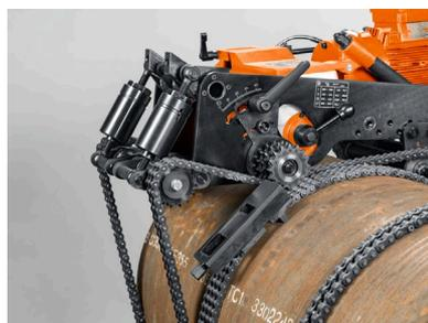
Didascalia: Catena di guida per operazioni di fresatura senza spostamenti.
