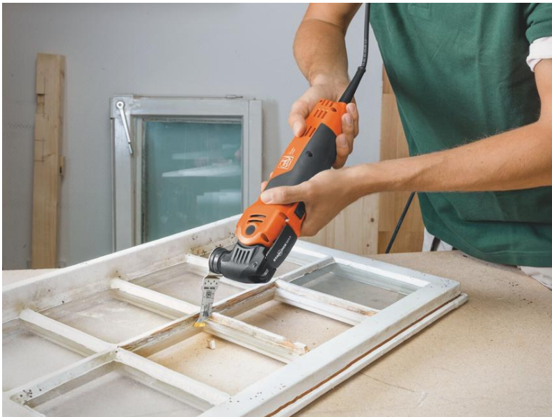
Pie de foto: Trabajo preciso en marcos de ventana con el FEIN MultiMaster y la hoja de sierra TiN adecuada.
