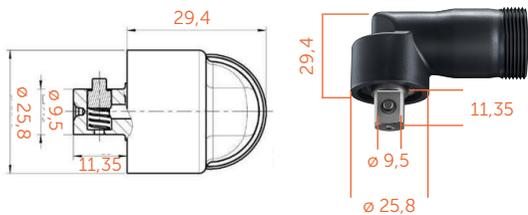
Winkelkopf 1/4 in QuickIN Innensechskant (DIN ISO 1173-F6,3) mit einem Eckmaß von 47 mm und einem Gewicht von 0,16 kg
