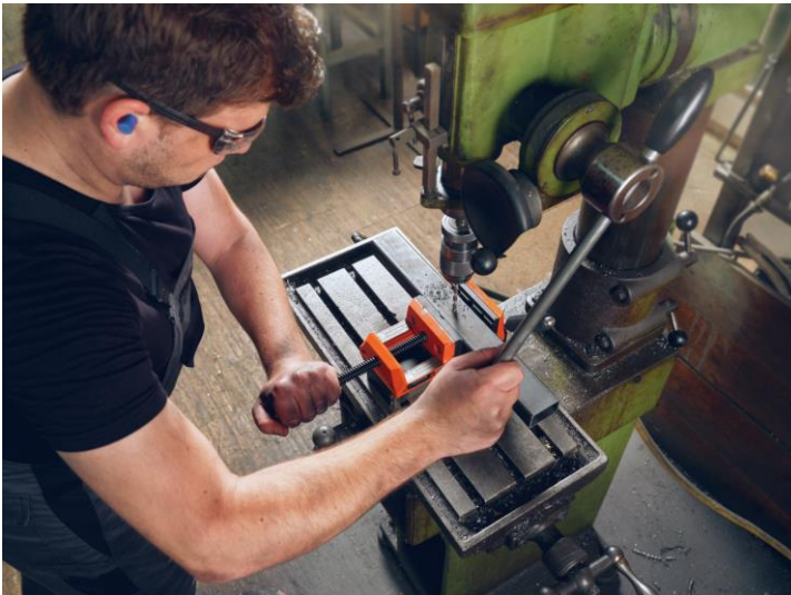
Légende : Alignement précis de l'étau magnétique grâce à une prémagnétisation de 30 %.
