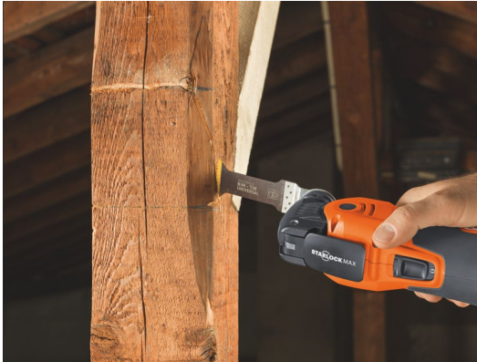
Légende : Sciage dans le bois avec la lame de scie bimétal avec revêtement en nitrure de titane 50x35 mm avec denture bois.
