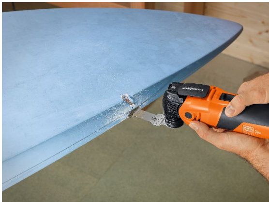
Légende : Sciage d'un matériel à base de résine composite avec la lame à concrétion diamant et le MULTIMASTER MM 700.tif
