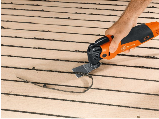
Légende : Nettoyage de joints avec le racloir et le MULTIMASTER MM 500
