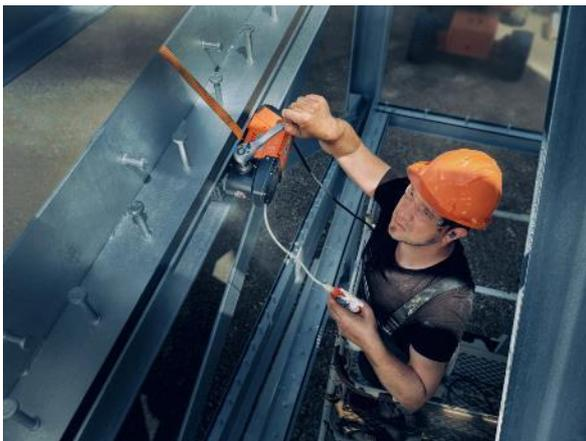
La KBC 36 MAGFORCE ne pèse que 8,5 kg au total, ce qui la rend idéale pour les travaux de perçage et de montage dans les endroits exigus et même en hauteur.
