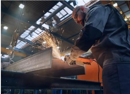
Résistante à la surcharge. Le fonctionnement de la meuleuse dans la plage de surcharge est signalé par une LED clignotante afin de protéger la machine et de réduire les temps d'arrêts.
