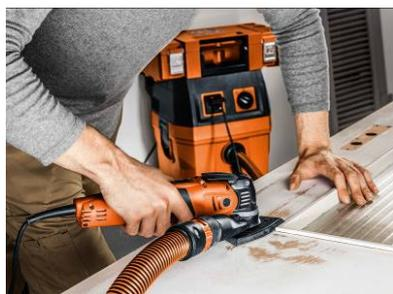
Légende : Le set d'aspiration avec flexible d'aspiration antistatique offre une protection efficace contre la charge électrostatique et contre l'exposition aux poussières de l'utilisateur et de son environnement.
