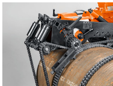
Légende : Chaîne de guidage pour des travaux de fraisage sans déviations.
