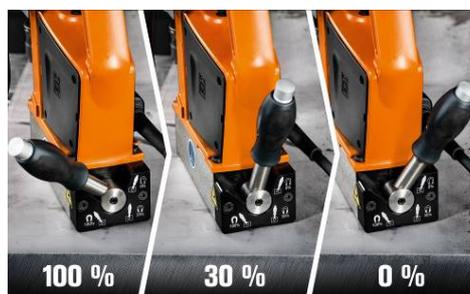
Légende : Polarisation magnétique de l'aimant permanent au moyen d'un levier mécanique.
