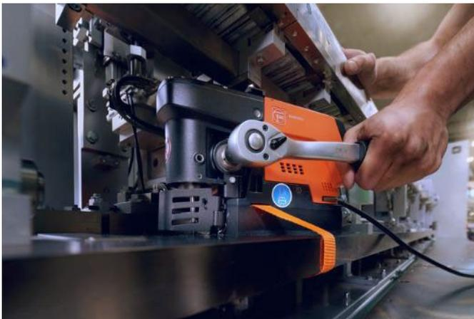
Imagen: la posición elevada del cabezal del MAGFORCE garantiza una buena visión de la máquina y del punto de perforación.
