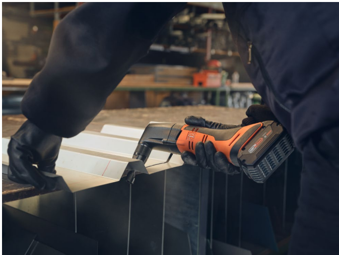
Imagen: La ABLK 18 1.6 E se caracteriza por su versatilidad. Puede utilizarse para cortes precisos en chapas trapezoidales y onduladas.
