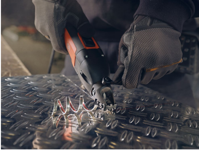
Imagen: Las cizallas ranuradoras BSS 1.6 CE FEIN con su cortador de virutas integrado permiten realizar cortes rápidos y limpios.
