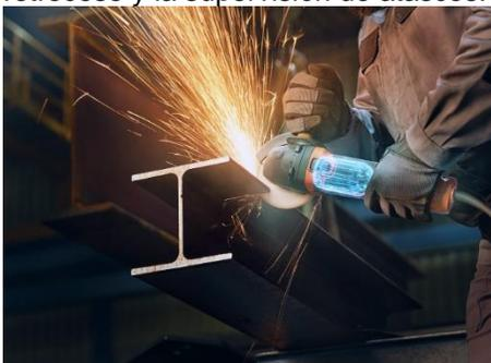
Protección perfecta: el motor FEIN PowerDrive sin escobillas, blindado y la electrónica del motor, montada por separado y con protección contra el polvo, hacen que la línea de productos CG-15 dure mucho más que los productos con motores universales.
