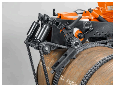
Pie de foto: Cadena guía para trabajos de fresado sin desalineación.
