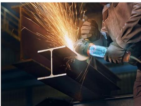
Perfekt geschützt: Der voll geschlossene bürstenlose FEIN PowerDrive Motor und eine staubgeschützte, separat verbaute Motor-Elektronik machen die CG-15-Baureihe im Vergleich zu Produkten mit Universalmotoren zu echten Dauerläufern.
