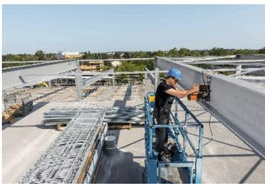
Bildunterschrift: Die leistungsstarke 1-Gang-Magnet-Kernbohrmaschine FEIN KBE 32 mit ihrem kraftvollen 1.200-Watt-Hochleistungsmotor ist ab Juni 2022 auf dem Markt erhältlich. Bei einem guten Preis-Leistungs-Verhältnis bietet sie Basisfunktionalitäten, die Kernbohrungen mit Durchmessern bis 32 Millimeter ermöglichen.
