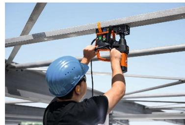
Bildunterschrift: Die Kernbohrmaschine ist mit 10,8 Kilogramm in ihrem Gewicht optimiert und eignet sich daher ideal für den Einsatz auf der Baustelle und bei Überkopf-Arbeiten. Der Magnet verfügt über eine Haltekraft von 10.000 Newton und ist mit einer Breite von 80 Millimeter sehr schlank gestaltet, wodurch die Maschine auch flexibel an Stahlträgern einsetzbar ist.
