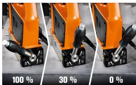
Bildunterschrift: Vormagnetisieren des Permanent-Magneten mit mechanischem Hebel.
