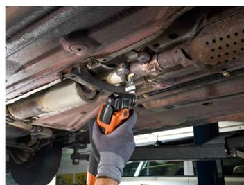
Bildunterschrift: Durchtrennt kurzerhand verrostete Auspuffschrauben.
