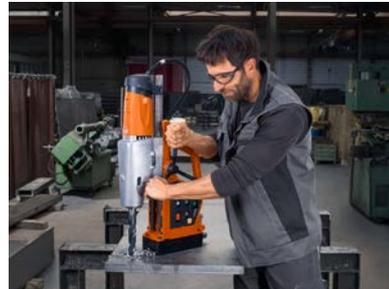
Bildunterschrift: Einsatz längster Bohrwerkzeuge durch Hub von 400 Millimeter
