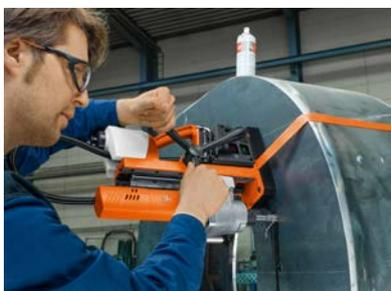
Bildunterschrift: Vertikaler Einsatz aufgrund von geringem Gewicht
