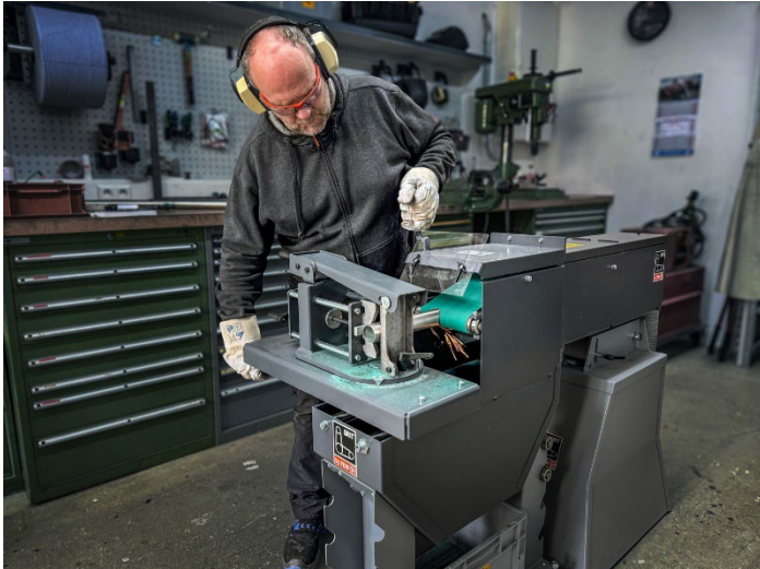
Bildunterschrift: Exaktes Ausschleifen von Radien an Rohren und Profilen mit einem Durchmesser von 20 bis 193,7mm.
