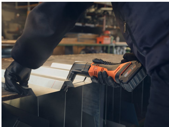
Légende : La grignoteuse ABLK 18 1.6 E se caractérise par sa maniabilité. Elle permet de réaliser des coupes précises dans les tôles trapézoïdales et ondulées.
