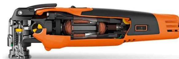
Bildunterschrift: Für den besten Schutz von Nutzern: Das FEIN Anti-Vibrationssystem senkt die Vibrationen und erhöht die Laufruhe. Das Gehäuse wird durch elastische Dämpfungselemente vollständig entkoppelt.
