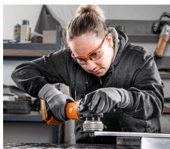
Bildunterschrift: Die neuen FEIN Kantenfräsen sind ideal für eine erstklassige Schweissnahtvorbereitung und zum Schutz von Oberflächen.
