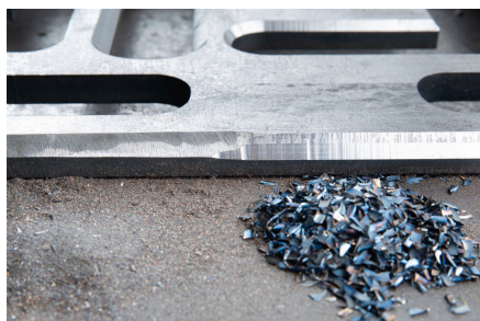
Bildunterschrift: Positiv für die Gesundheit: Bearbeiten Anwender die Kanten des Werkstücks mit einer Kantenfräse, entstehen Metallspäne und keine metallischen Stäube.
