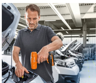
Bildunterschrift: Der FEIN ASM 18 erreicht Drehmomentbereiche von 0,5 bis 12 Newtonmeter.
