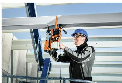
Bildunterschrift: Permanent-Magnet für sehr sicheres Arbeiten in der Höhe.
