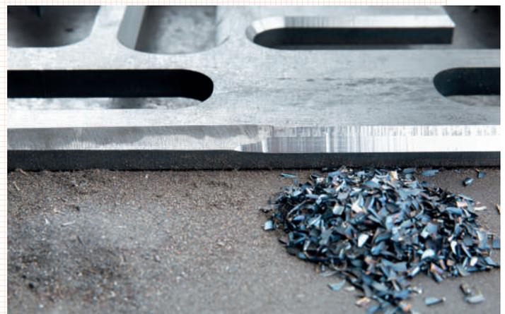
Vergleich zweier bearbeiteter Kanten – links die Arbeit eines Winkelschleifers: **Nur rechts mit der Kantenfräse entstehen präzise Fasen und somit DIN-konforme Schweissnähte.**
