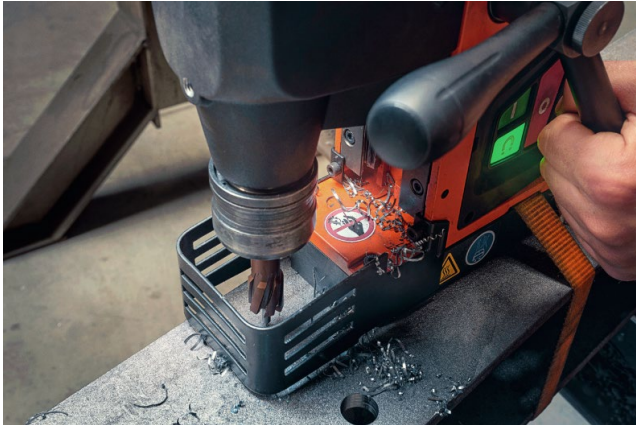
Bildunterschrift: Trotz des extrem leistungsstarken bürstenlosen 1.600 W-Hochleistungsmotor bringt die KBE 36 QW MAGSPEED nur 11,0 kg Maschinengewicht auf die Waage.
