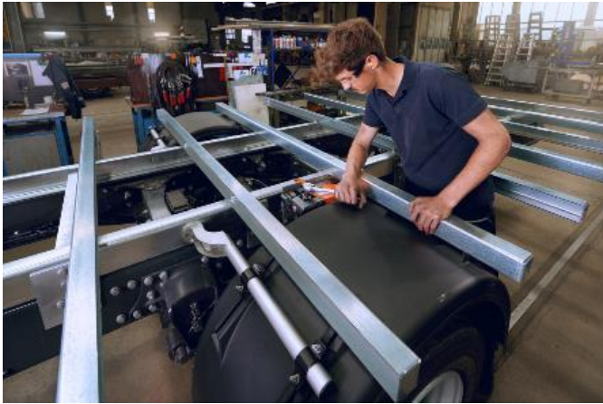
Bildunterschrift: Die neue FEIN KBC 36 MAGFORCE ist die kompakteste Magnet-Kernbohrmaschine auf dem Markt, die über einen Rechts-/Linkslauf verfügt. Durch ihre geringe Baugröße kann sie selbst an schwer zugänglichen Stellen im Fahrzeugbau eingesetzt werden.
