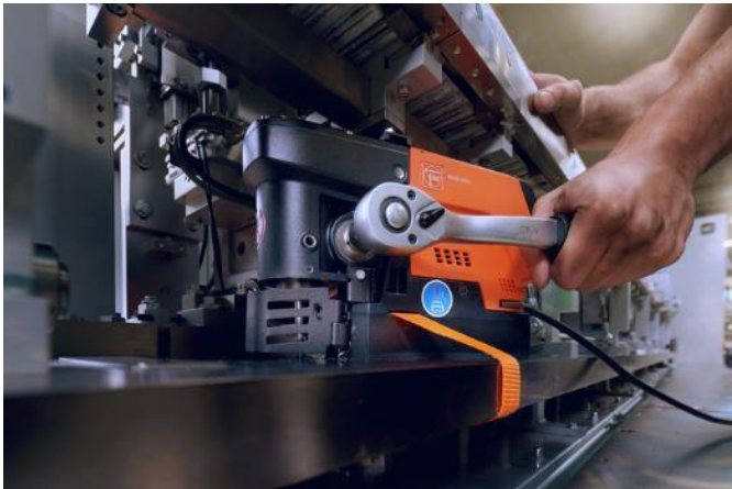
Bildunterschrift: Der hohe Getriebestand der MAGFORCE sorgt für eine gute Sicht auf das Bohrwerkzeug und auf die Bohrstelle.
