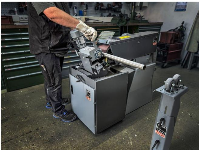
Bildunterschrift: Rundschleifen mit Rohrdurchmessern von 10 bis 130mm mit dem Modul GIC.
