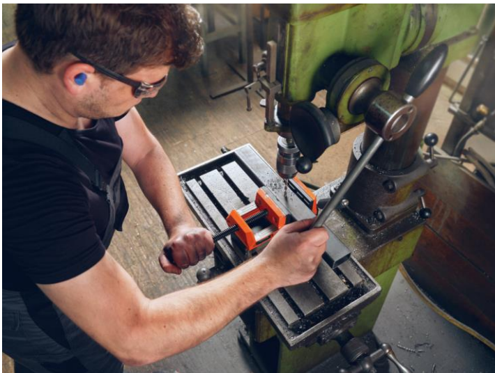
Bildunterschrift: Präzise Ausrichtung des Magnetschraubstocks mithilfe einer 30 %-igen Vormagnetisierung.
