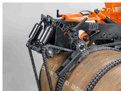
Bildunterschrift: Führungskette für Fräsarbeiten ohne Versatz.
