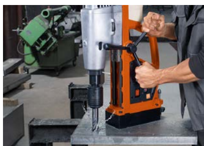
Bildunterschrift: Zubehör zum universellen Arbeitseinsatz, etwa zum Gewindebohren
