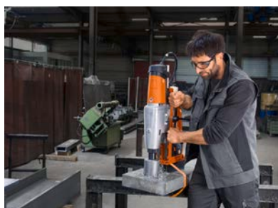
Bildunterschrift: Kernbohrungen mit Durchmessern von bis zu 110 Millimeter
