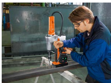
Bildunterschrift: Durch Hubbereich von 260 mm sind lange Bohrwerkzeuge einsetzbar
