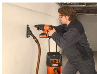
Bildunterschrift: Zum Schutz des Anwenders: Bohrstaubdüse für staubarmes Arbeiten
