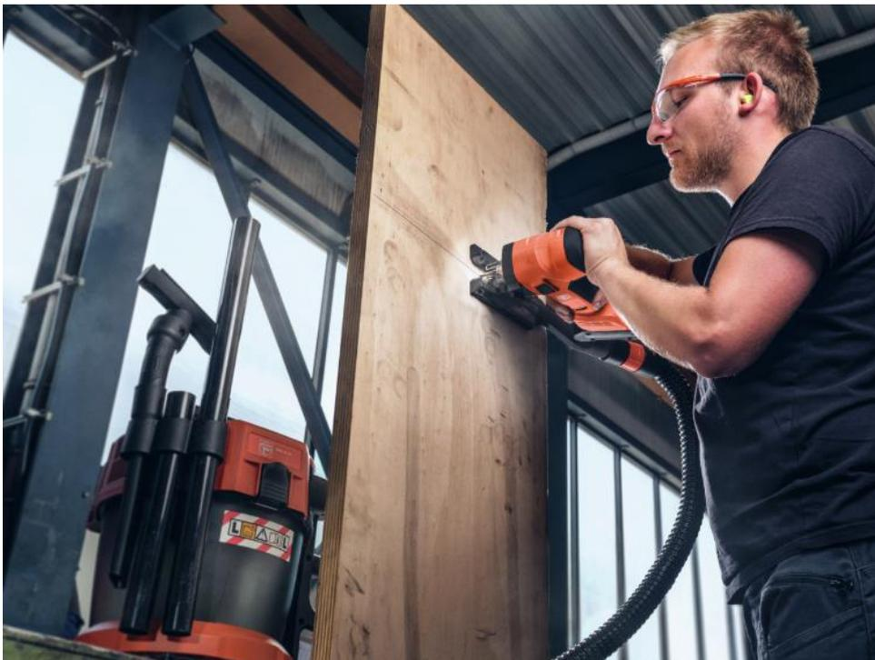
Traitement des matériaux les plus divers (métal, bois, plastique, etc.) et des profilés tels que les matériaux ronds et pleins grâce au réglage de la vitesse de rotation et de la course pendulaire, et un grand choix de lames de scie.
