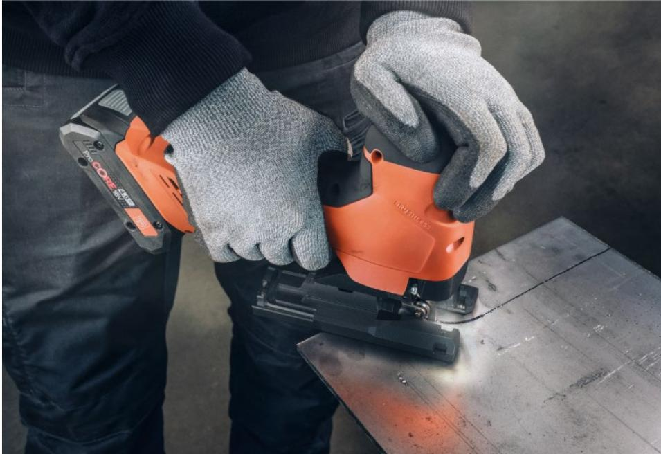
Durch die Abluft des Lüfterrads bleibt die Schnittkante frei von Spänen. Und dunkle Stellen sind mit LED hell beleuchtet
