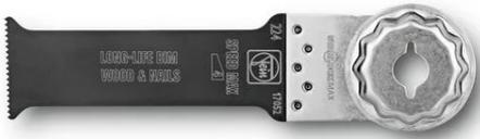
Bimetal con dentado de madera trabado para todos los materiales derivados de la madera, placa de cartón-yeso y plástico. Duración excelente, elevada calidad de corte y buena velocidad de corte. Excepcionalmente robusta, insensible también frente clavos (hasta aprox. Ø 4 mm), mampostería, etc.
